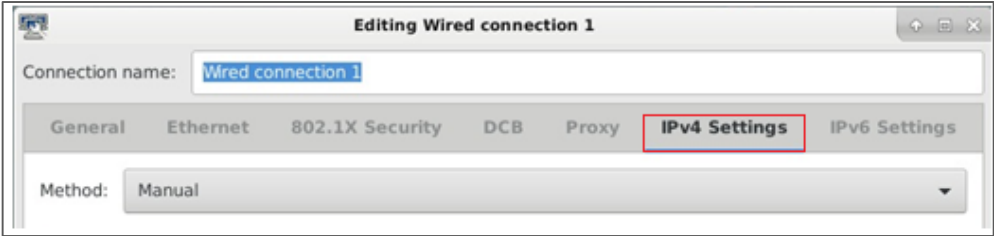
Рисунок 3.18 – Экранная форма службы «Network Connections» с выбором вкладки «IPv4 Settings»
